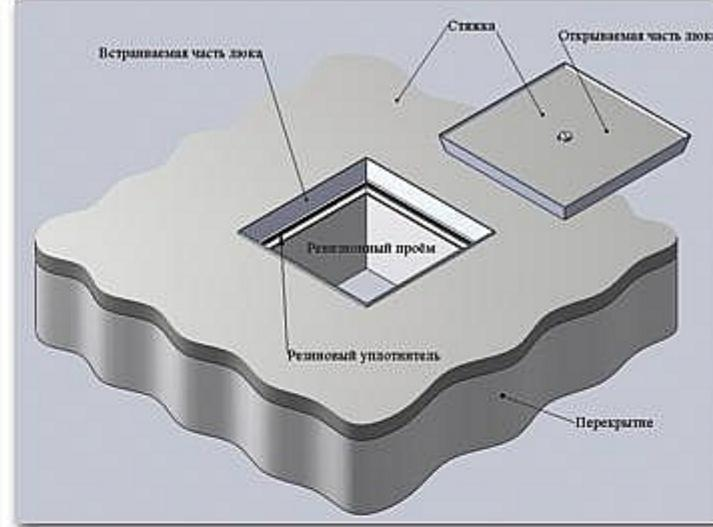
Залить стяжкой перекрытие до верхнего края внешней рамки и заполнить раствором крышку люка
